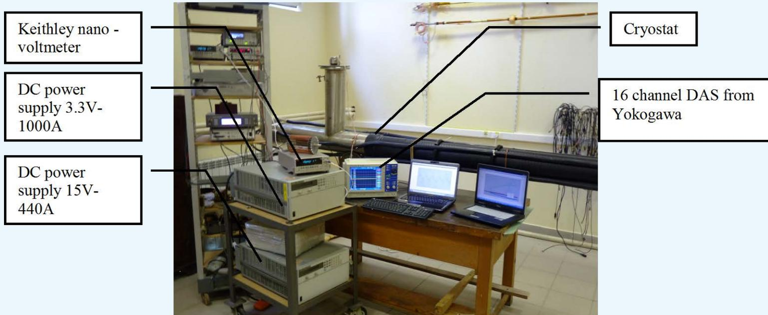
**LOW VOLTAGE HIGH CURRENT TEST FACILITY IS EQUIPPED BY:**
