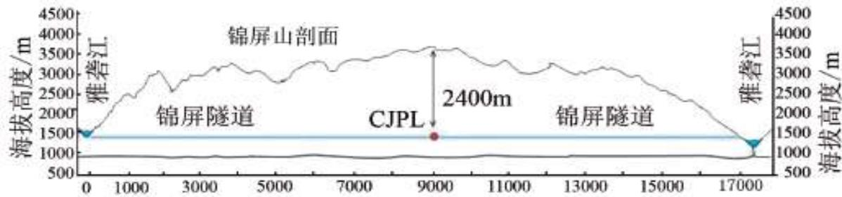
图 10 锦屏山剖面图及中国锦屏地下实验室位置示意图
